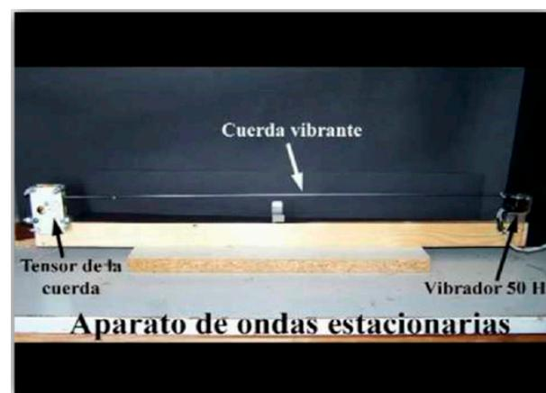
**Imagen 1.** Representación gráfica de un aparato de ondas estacionarias. Imagen obtenida en [www.gatopardos.com/ESTACIONARIAS/1](http://www.gatopardos.com/ESTACIONARIAS/1)
